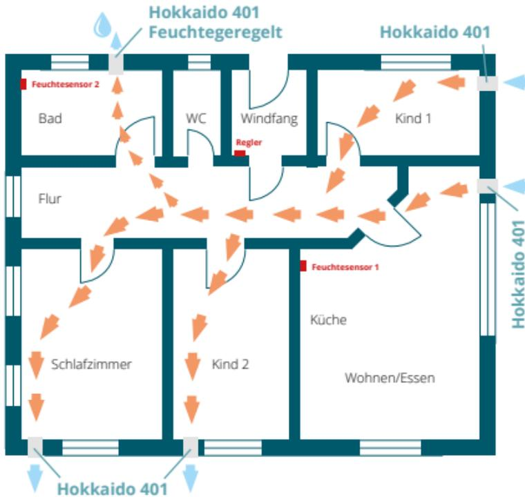
Der EnOcean-Sensor vergleicht die Werte im Bad (2) mit den Messwerten in Wohnräumen (1). Dabei orientiert sich die Entlüftung an Referenzwerten, die für Innenräume anvisiert werden. Wird ein Unterschied bemerkt, schaltet sich der Badlüfter automatisch ein, und wieder aus sobald die Referenzwerte erreicht ist.
