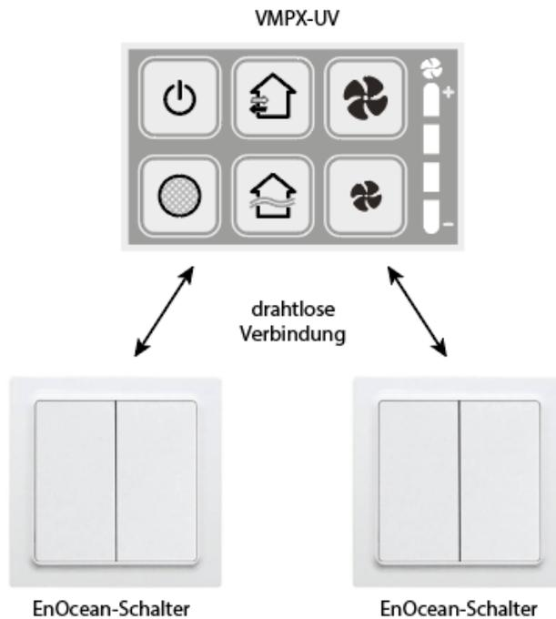
Der Controller VMPX-UV kann mit bis zu 8 externen EnOcean-Schaltern verbunden werden.
